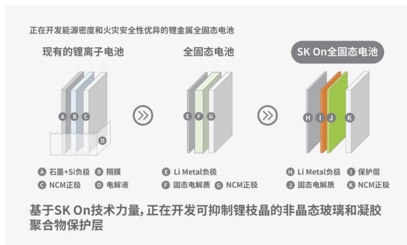
图：SKI全固态电池结构设计
