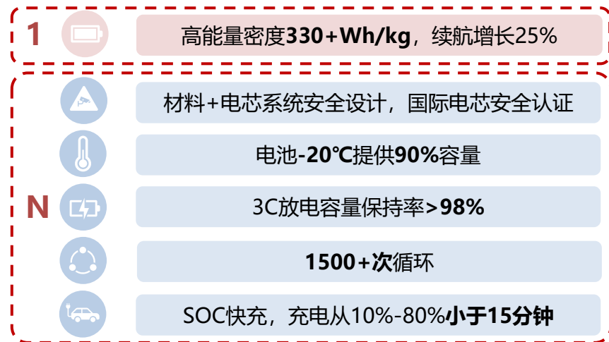
图 孚能科技330Wh/kg半固态软包技术的“1 + N”
