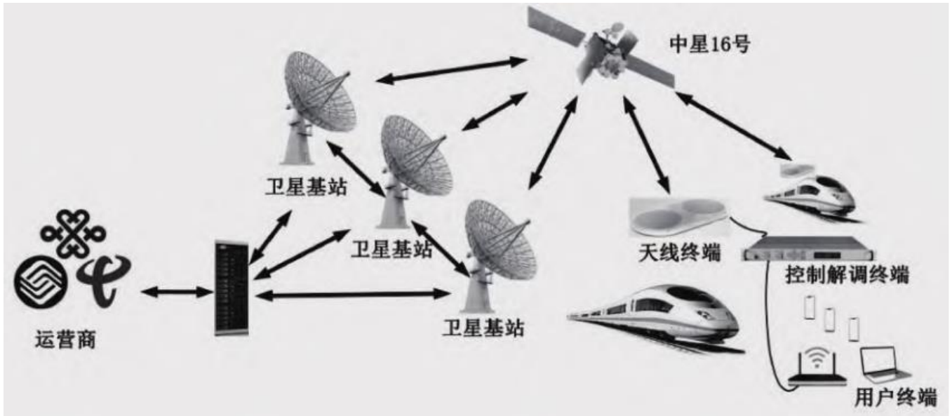
图表 23 基于宽带卫星互联网的动中通系统
