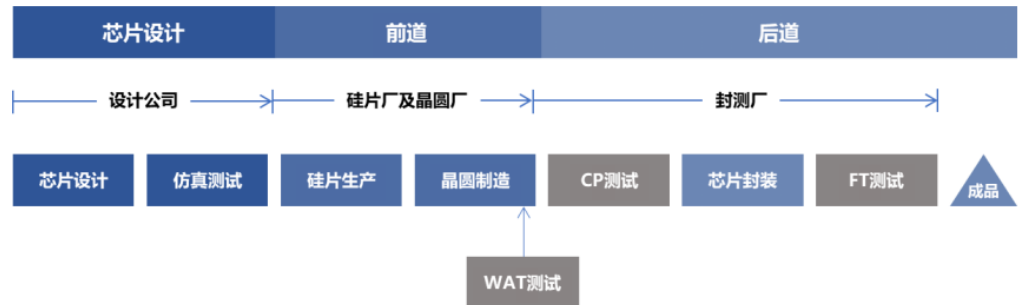
图40: 电性测试在集成电路生产制造各环节中的应用
