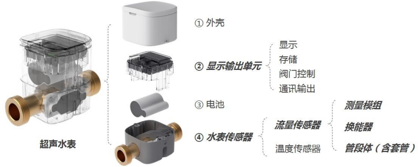
图19：汇中股份超声水表产品结构
