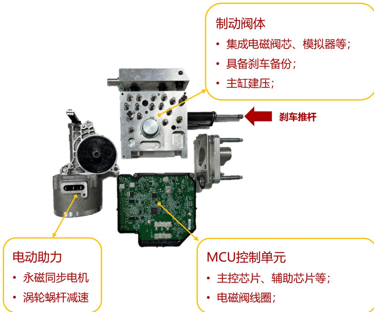
**制动阀体:** 采用机加工工艺, 内部包含众多机加工通道, 通过电磁阀控制各大通道开关, 控制各个车轮的制动力大小;
