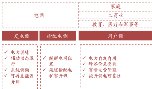
图 19：储能在电力系统中的应用场景分类
