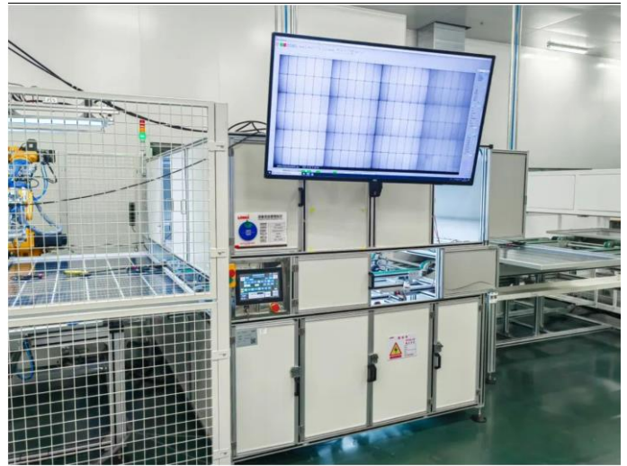
图5：隆基组件生产中利用 EL/外观 AI 检验技术
