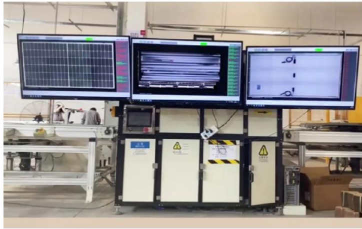
图33：终检外观检测设备用于光伏组件出货前外观自动检测
