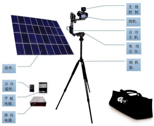
图29：便携式 EL 检测可满足组件 EL 现场测试需求
