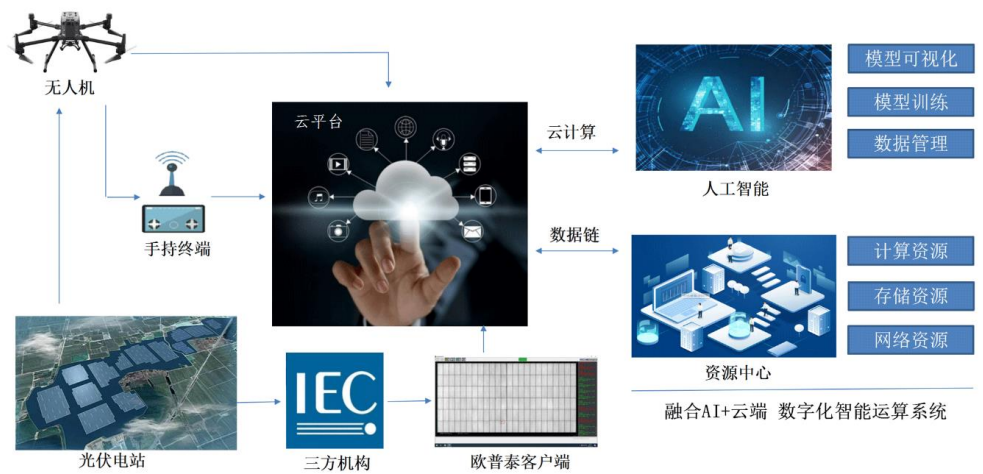
图50：光伏电站无人机自动运维系统主要由无人机 EL 检测设备和电站云平台构成
