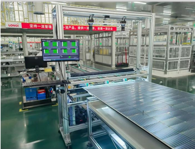
图4：隆基组件生产厂中利用 AI 自动测量技术
