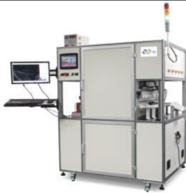
图22：电池片 EL 检测设备为电池片环节主要产品之一
