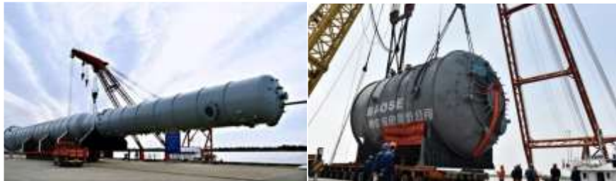
图73：炼油装置的塔器设备及化工PTA装置的反应器
