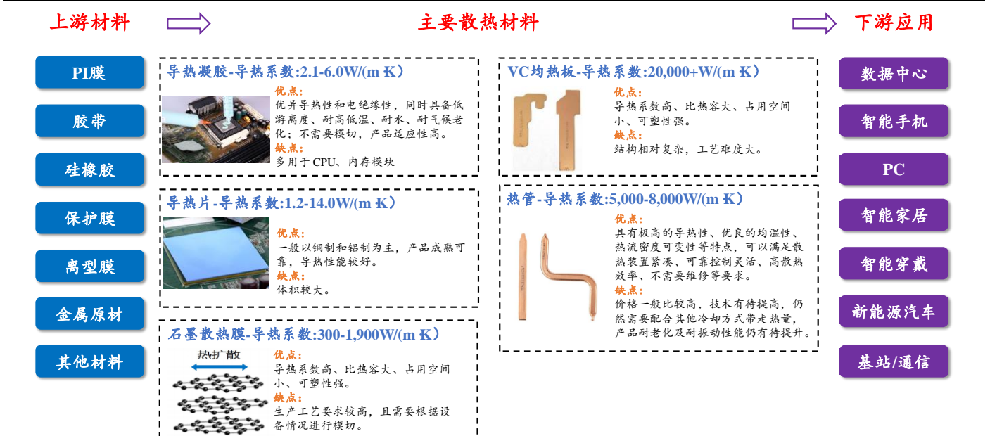
图3: VC 均热板具有较高的导热系数，为具有较大发展潜力的散热材料
