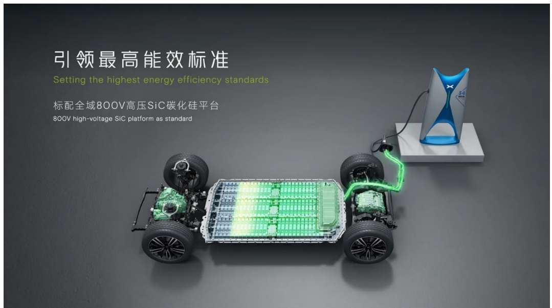
图 47: 800V 高压 SiC 碳化硅平台
