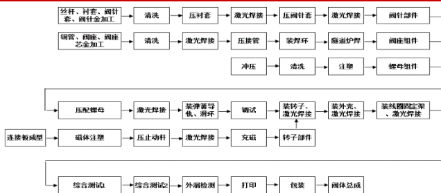
图 7 空调用电子膨胀阀工艺流程
