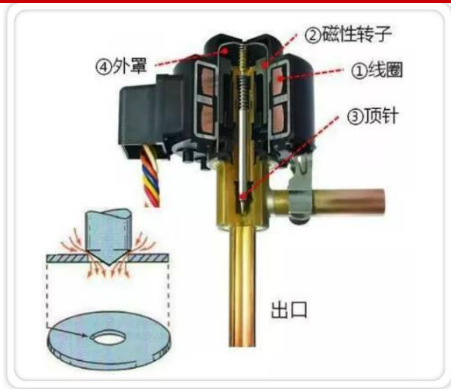
图 5 电子膨胀阀结构
