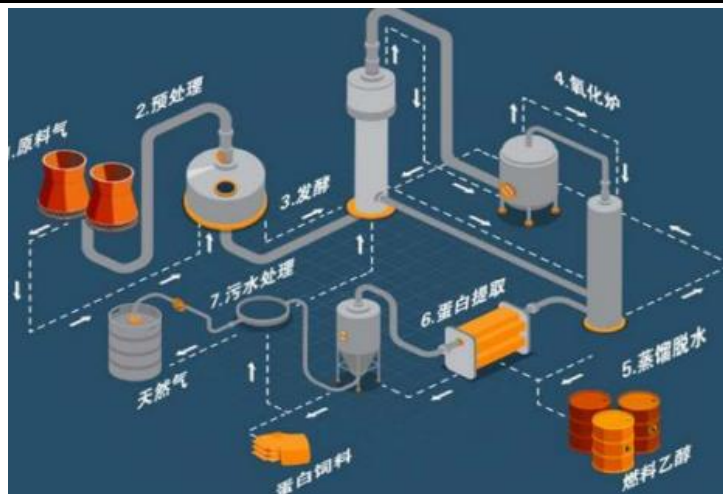
图20: 工业尾气制乙醇流程图
