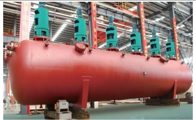
图28：钛钢复合板加压釜用于动力电池制造
