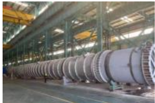
图14：锆金属应用到醋酸塔器制作中
