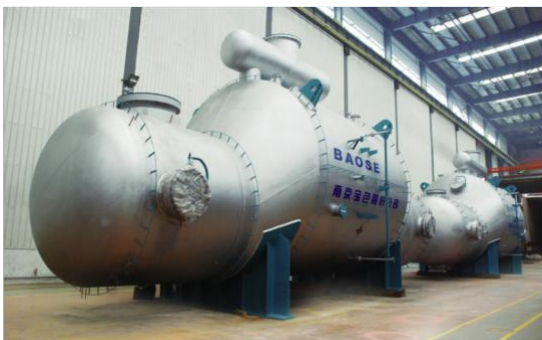
图13：钛金属应用到 PTA 冷凝器制作中
