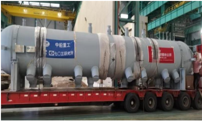
图36: 公司蒸汽发生装置用于光热电站
