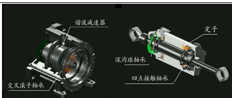
图9：特斯拉机器人根据不同位置的受力特点选用不同轴承
