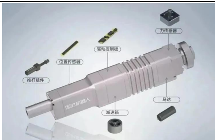
图17: 灵巧手内的执行器是一个微型伺服电缸
