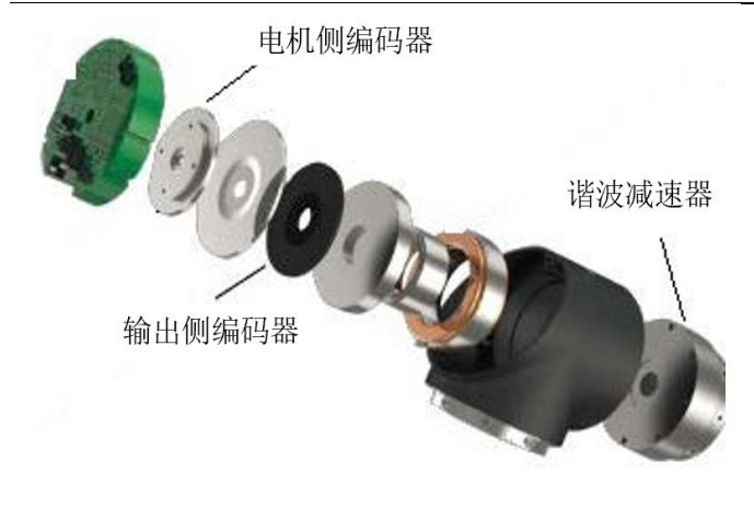
图20：协作机器人关节模组中采用双编码器
