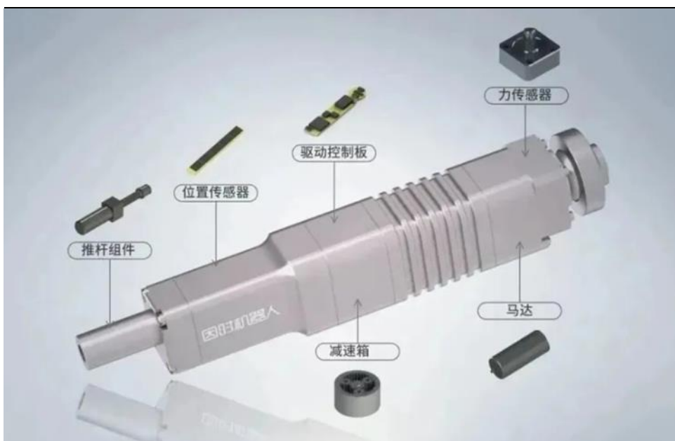
图35：灵巧手内的执行器是一个微型伺服电缸
