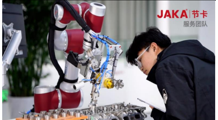
图23：节卡机器人发动机装配中使用六维力传感器
