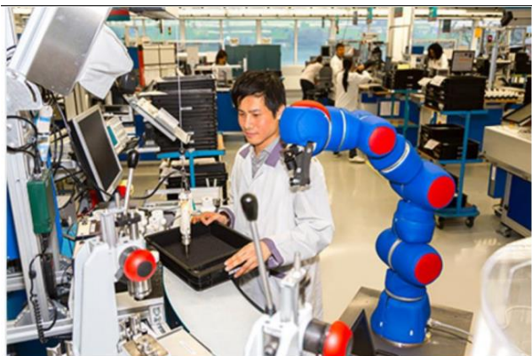
图33: Maxon 无框电机应用于协作机器人关节
