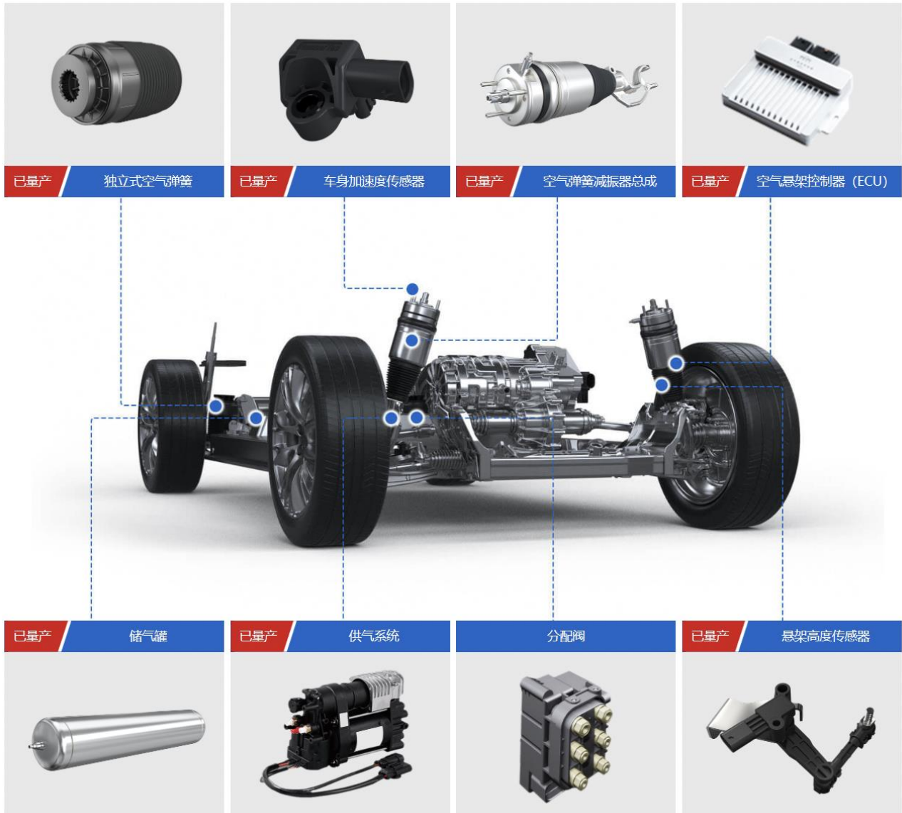
图表 3 空悬系统各部件示意图
