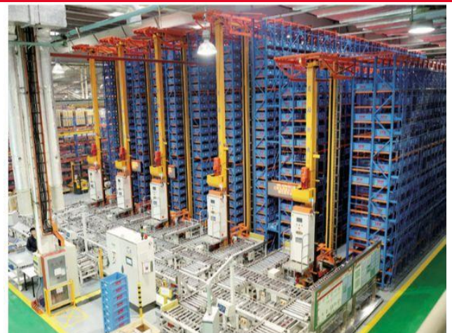
图10 SEW 天津工厂箱式自动化立体库
