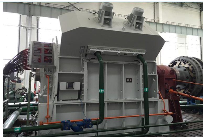
图27：10MW船用推进电机
