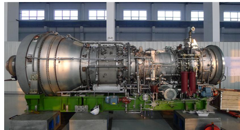
图26：25MW级工业型燃气轮机
