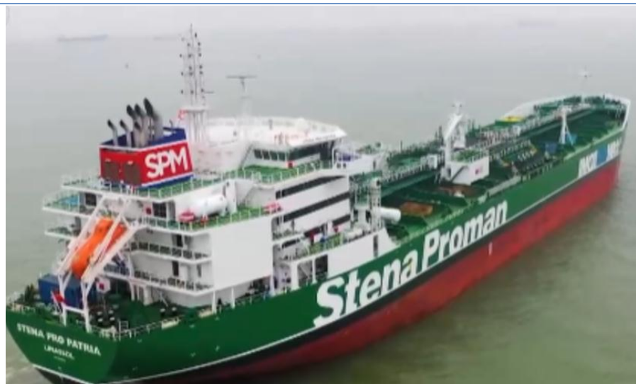
图23：4.99万吨甲醇双燃料动力化学品/成品油船
