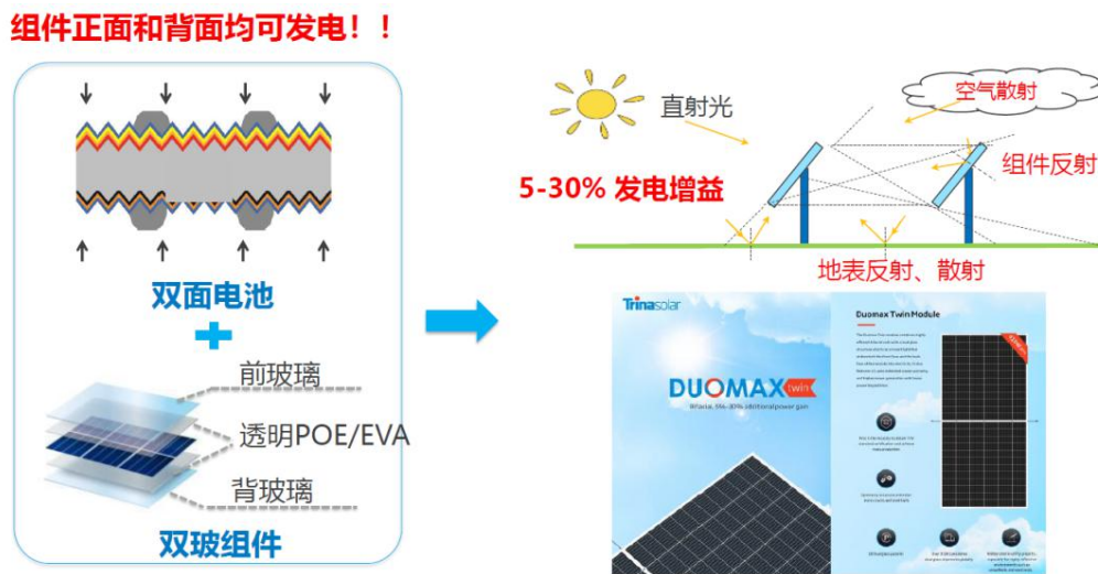
图 45：双面光伏组件原理
