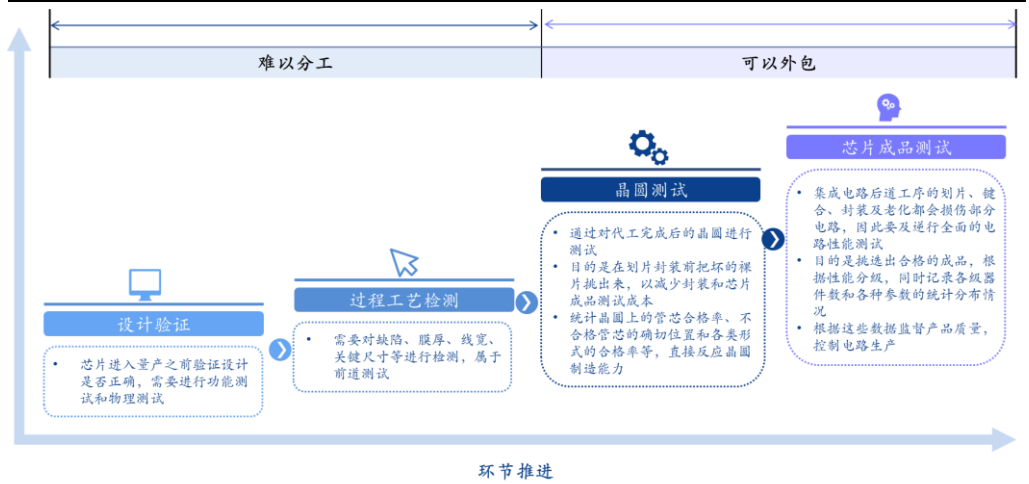
图4：晶圆测试和芯片成品测试环节是专业测试公司主要业务形态
