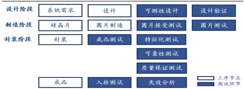
图2：测试贯穿于集成电路生产过程
