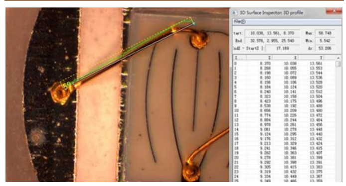
图 17：后道焊点间长度的测量
