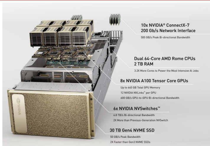
图18: 英伟达第三代 DGX (DGX A100) 设备构成
