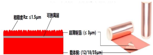
图 7： 带载体可剥离超薄铜箔结构
