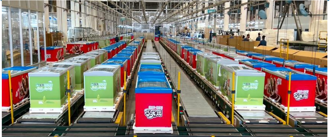
图13: 公司生产线柔性化体现之一: 同条生产线可生产不同品牌商产品
