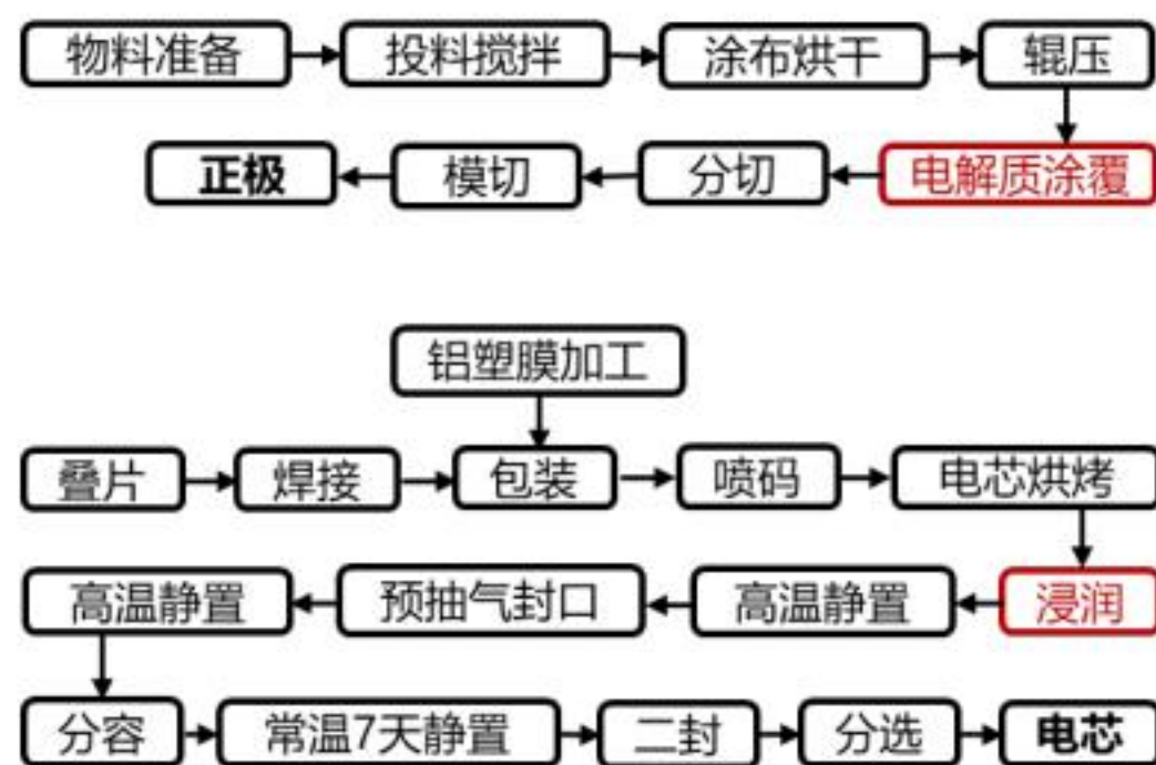
图 清陶能源正极、电芯生产工艺
