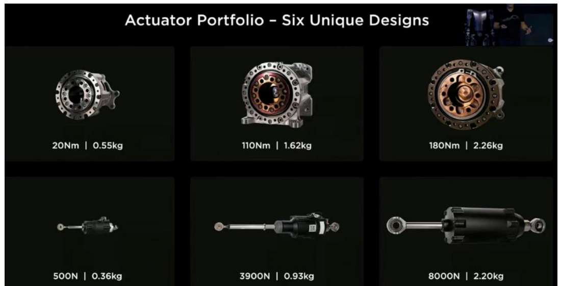
图18：特斯拉“Optimus”采用行星丝杠作为下肢的线性驱动器
