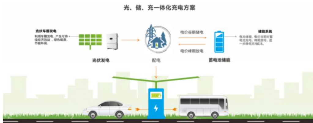
图 16：光、储、充、放一体化充电流程
