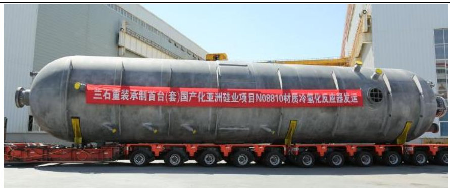
图15：公司完成首台国产化冷氢化反应器（N08810材质）装置
