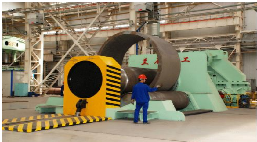
图2：公司自行研制重型全液压四辊卷板机，提升了制造能力
