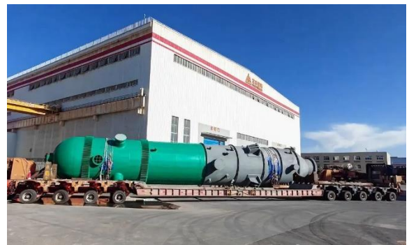
图21：中海油惠州石化煤气化制氢项目气化炉
