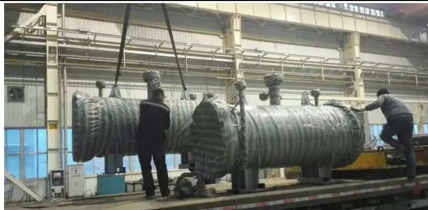
图25：公司为甘肃阿克塞高温熔盐型光热发电项目制造的熔盐储罐及热/冷罐出厂
