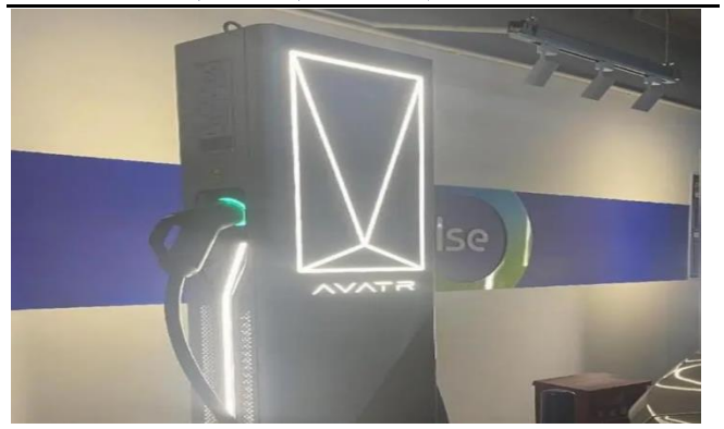
图 33: 阿维塔高压快充峰值输出功率达 480kW
