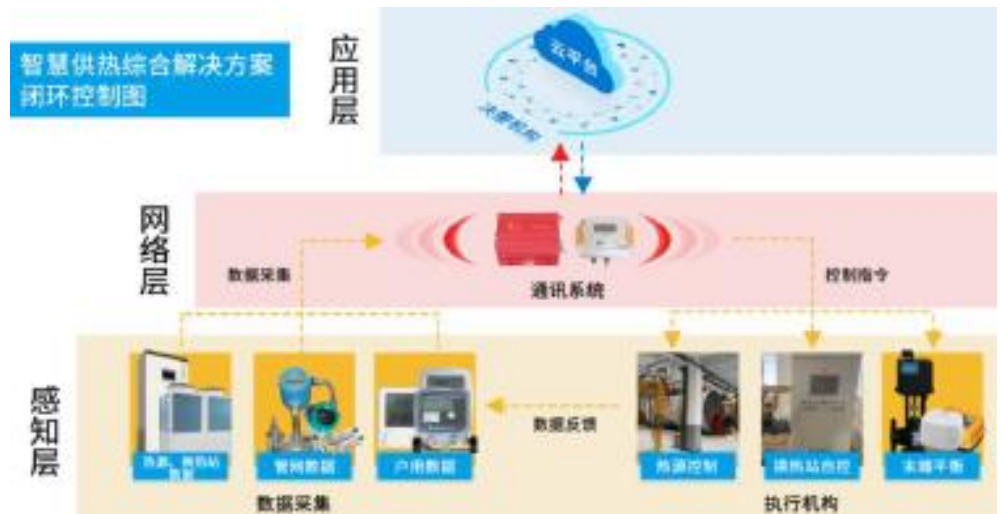
图18：供热类产品组成由数据采集、传输、分析处理到终端反馈执行的解决方案
