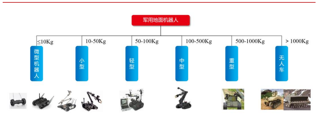
图26: 军用地面机器人一般可按平台重量划分
