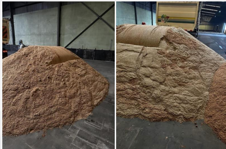
图23：准备装运的绿色尾矿，将被升级为电池级锂精矿
