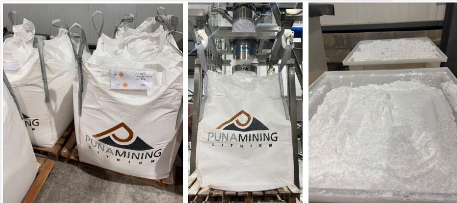
图32：Salar del Rincon项目--2000吨/年碳酸锂项目调试中的产品
