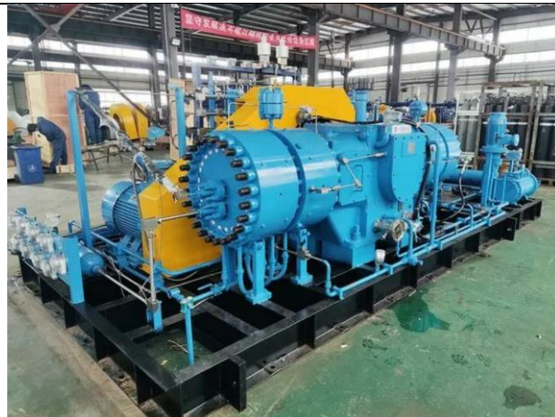
图表 72 丰电科技参与研发的我国首台专门为 70MPa 加氢站研发的氢气压缩机
