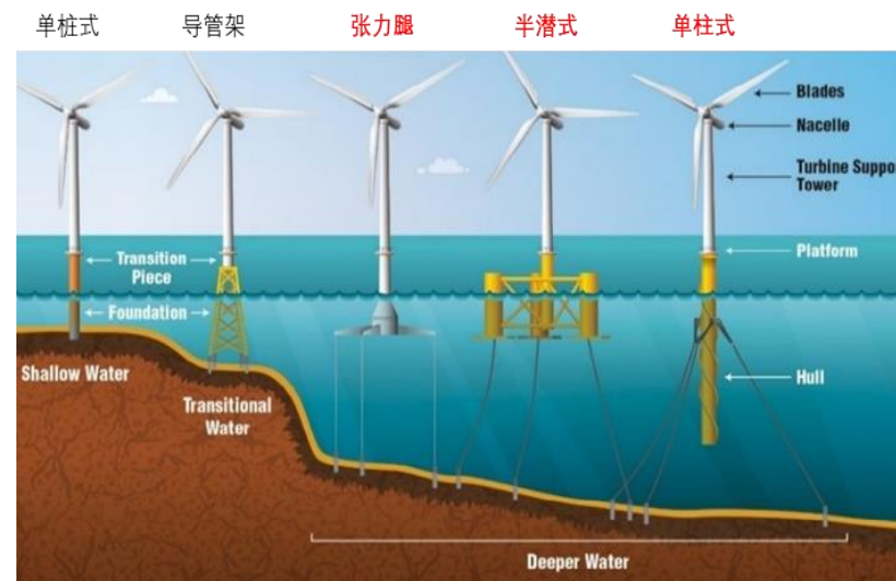
适应不同水深的海上风电基础结构示意图
