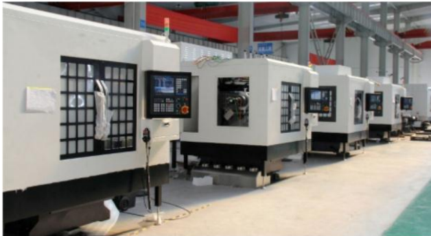
▲湖南宇环智能装备公司批量配置华中8型系统的五轴抛光机车间
