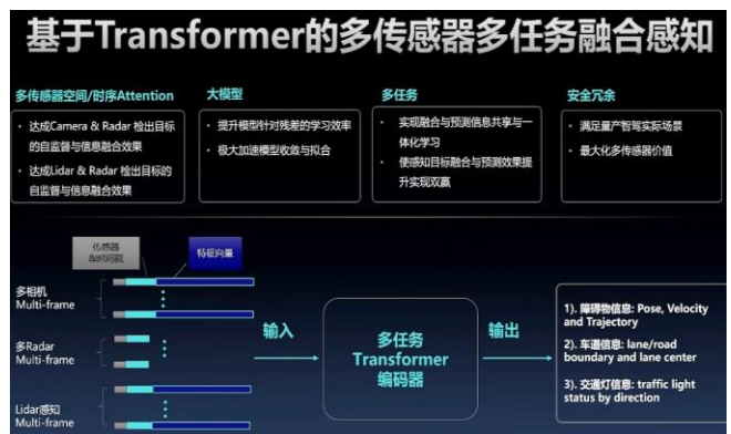
图55: 比亚迪多传感器 BEV+TransFormer 架构
