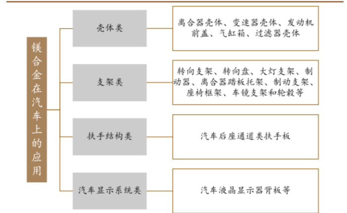
图 20：镁合金可用于汽车壳体、支架、扶手结构以及汽车显示系统等多领域
