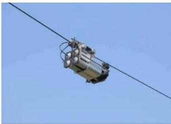
架空配电线路裸露导线存在安全隐患，该机器人可在线路上带电进行绝缘包覆。
