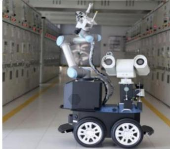
在搭载可见光镜头的基础上增加了多自由度作业机械臂和专业作业工具，可对变电站室内设备进行一定的操作。
