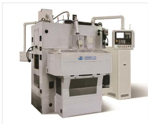
YHMM7776 精密级数控立式双端面磨床
