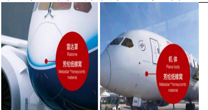
图28：芳纶纸蜂窝应用于雷达罩、机体等结构件
