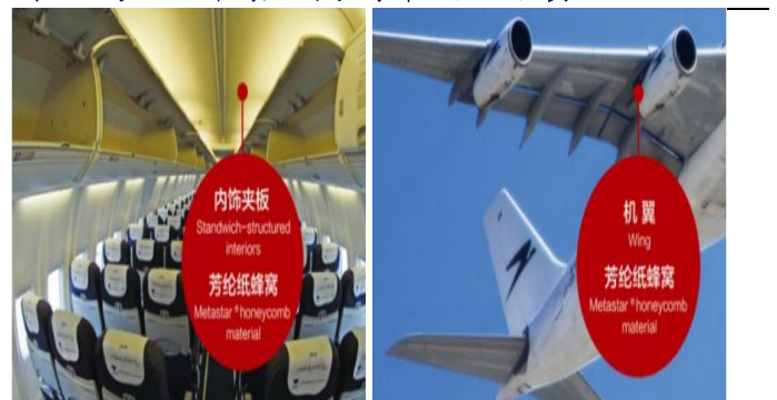
图29：芳纶纸蜂窝应用于内饰夹板、机翼
