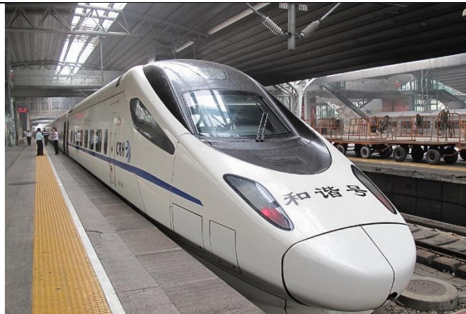
图44：和谐号 CRH5 型采用芳纶纸蜂窝作为内饰材料
