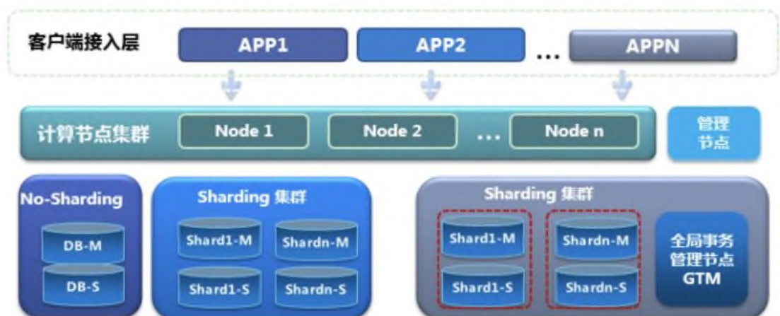
图 37: 中兴通讯 GoldenDB 分布式数据库架构
