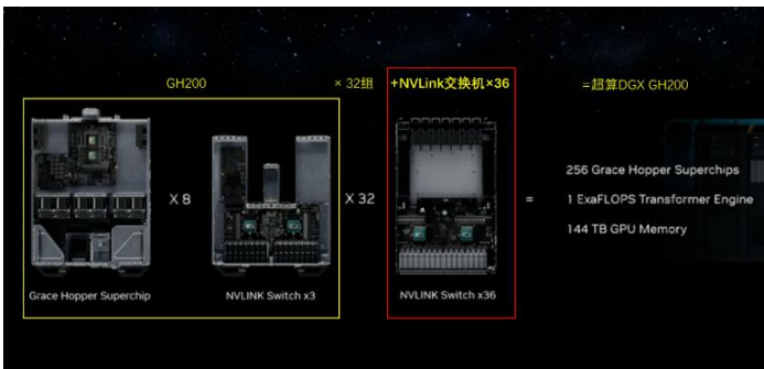
图表41: 超算 DGX GH200 在 L2 网络层搭配 36 个交换机
