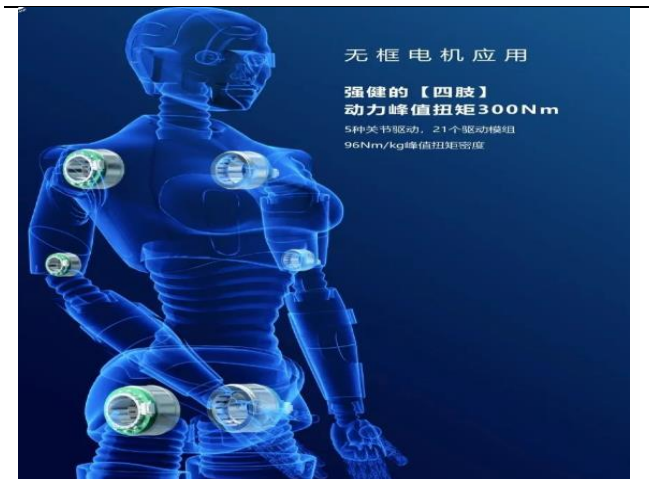
图表 33：无框电机在人形机器人领域应用
