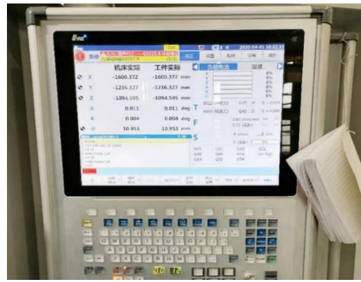
图23: 华中数控 HNC-848D 系统实现五轴 RTCP 功能
