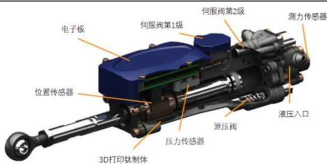
图14：液压传动是机器人机器人关节驱动的重要方式
