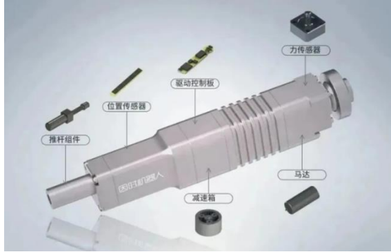
图6：灵巧手内的执行器是一个微型伺服电缸
