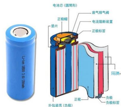
图16 圆柱电池内部结构
