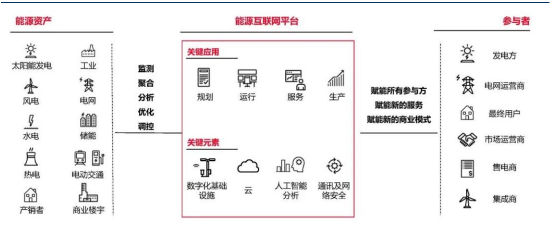
图表11: 虚拟电厂产业链由上游能源资产、中游运营平台和下游虚拟电厂需求方组成
