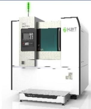
内螺纹磨床：可加工直径10-200mm，长度125mm以内的各种齿形内螺纹，参照滚珠丝杠精度国标，磨削精度可稳定达P1级
