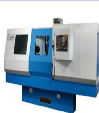
高速外圆磨床：可加工直径5-200mm，长度750mm以内的各种轴类零部件，配置FANUC磨床专用系统，可很好保证磨削状态的一致性
