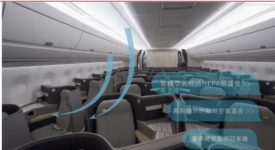
图40: 飞机座舱空气环境控制示意图
